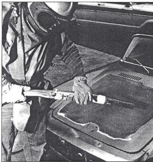
Farbschicht um Farbschicht wird durch das mit hohem Druck aus der Düse geblasene Plastikgranulat entfernt. Zurück bleibt blankes Karosserieblech, welches durch das Aerolyte-Verfahren weder Aufrauung noch sonstige Veränderungen erleidet.
